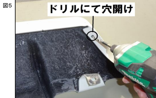
図5 5.エアロパーツにエビナットを打ち込みます。(図5.6.7参照) 取り付け時に、図4にて穴を開けた箇所にM5ボルトを使用して固定をします。
