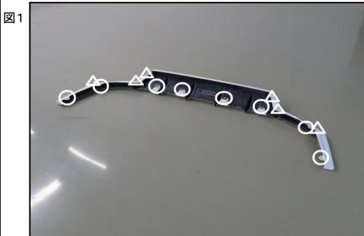
図1 1.○印は純正部品、△印は付属品を使用します。
