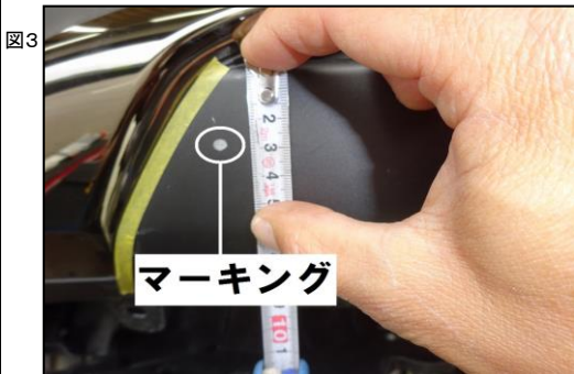
図3 3.図3のように、約30mmの所にマーキングをしてください。
