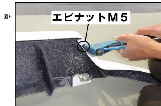
図5 5.エアロパーツにエビナットを打ち込みます。(図5.6.7参照) 取り付け時に、図4にて穴を開けた箇所にM5ボルトを使用して固定をします。
