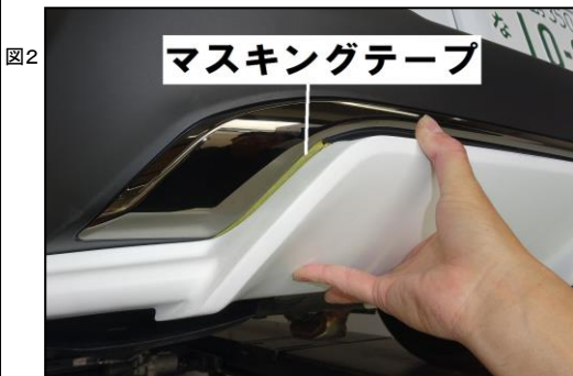
図2 2.純正バンパー中央部にマスキングテープを貼り、純正バンパーに引っ掛けるように仮合わせをしてください。純正部品、マスキングテープなどを使用して動かないように固定してください。
