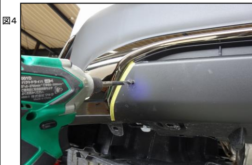
図4 4.図4のように先程のマーキング位置に6mmの穴を開けます。
