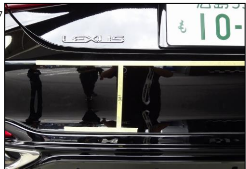
12.図16部分のリアバンパー側面と、モール上部の長さが190mm 図17部分のバンパープレスラインから、モール上部の長さが185mm
