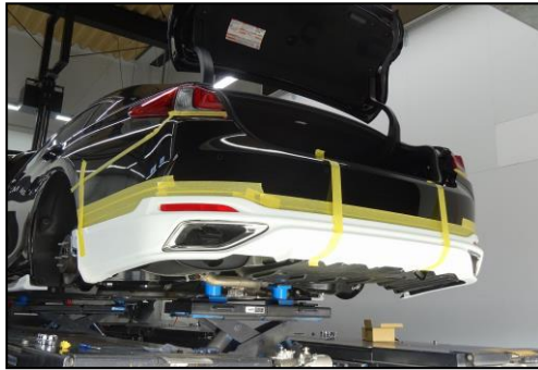
6.エアロパーツを仮合わせします。 ボディに被さる箇所をマスキングテープなどでキズがつかないようにしてください。 位置出しは、図16.17.18を参照
