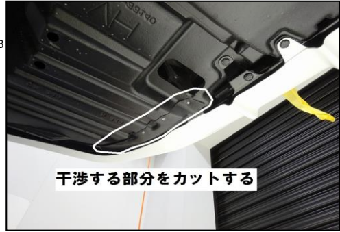
9.アンダーカバーが干渉する為、短くカットをしてください。 デモカーはカットをして、リベットを使用して繋げてます。
