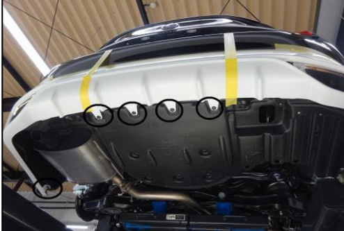
8.下側の部分は純正部品を使用して固定します。
