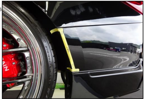
11.ゴムモールを貼り付けます。しっかりと脱脂をしてください。
