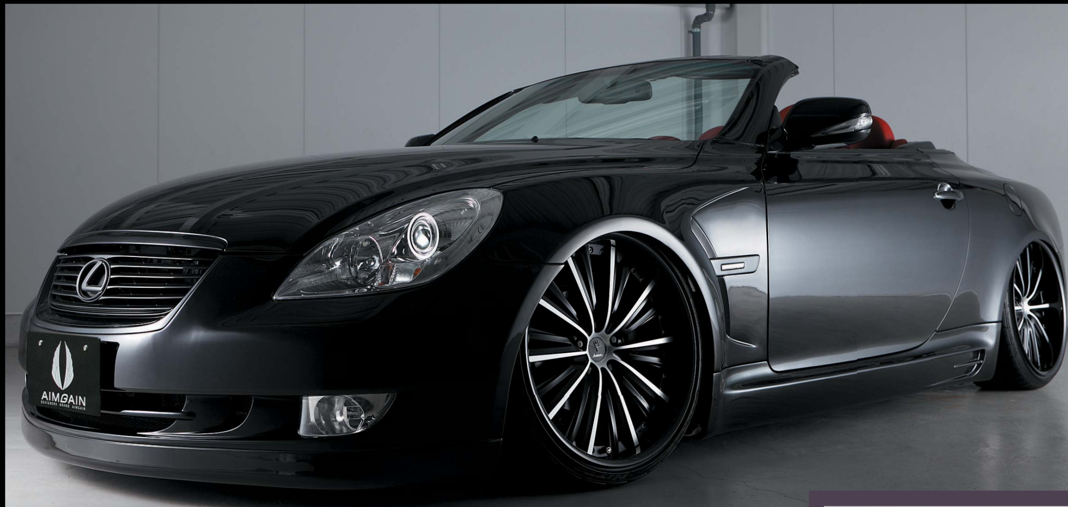
【Kranze MAGISS】 SSIZE : [FRONT] 20×9.0J INSET 24(LO) MAT BLACK / POLISH [REAR] 20×10.0J INSET 25(LO) MAT BLACK / POLISH (20mmSPACER INSERT) SPECIAL THANKS : WEDS 【NITTO NEO GEN】 SIZE : [FRONT] 235/30-20 [REAR] 245/30-20
