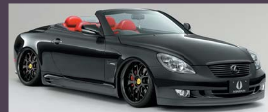
【Kranze MAGISS】 SSIZE : [FRONT] 20×9.0J INSET 24(LO) MAT BLACK / POLISH [REAR] 20×10.0J INSET 25(LO) MAT BLACK / POLISH (20mmSPACER INSERT) SPECIAL THANKS : WEDS 【NITTO NEO GEN】 SIZE : [FRONT] 235/30-20 [REAR] 245/30-20
